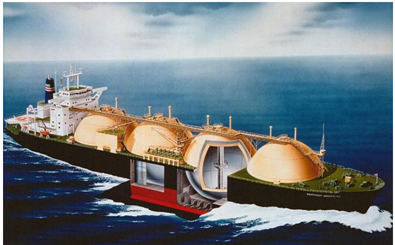
Разрез грузового помещения судна-газовоза
