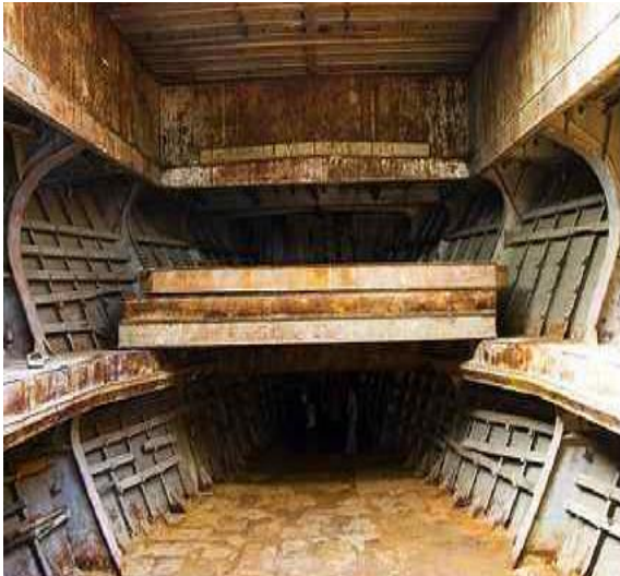
Грузовые помещения судна: трюм и твиндек (расположен выше трюма).
