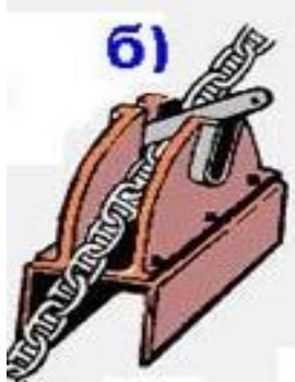
Стопор винтовой: 1-дуга, 2 зажимная колодка, 3 винтовой шпindelь, 4-рукоятка, 5-подушка
