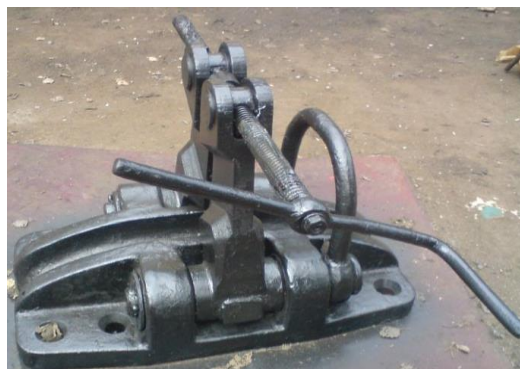
Стопор винтовой: 1-дуга, 2 зажимная колодка, 3 винтовой шпindelь, 4-рукоятка, 5-подушка
